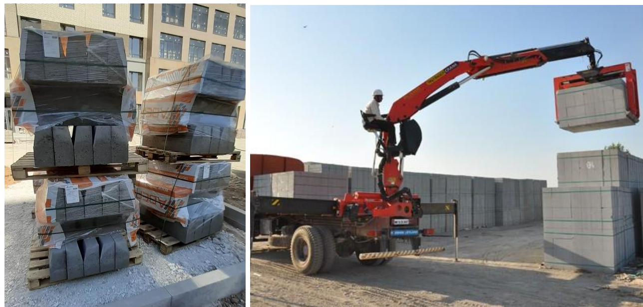
Рисунок 4 – Примеры упаковки и складирования бортовых камней
