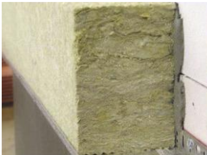
Рисунок 16 - Теплоизоляционная плита из минеральной каменной ваты на клее
