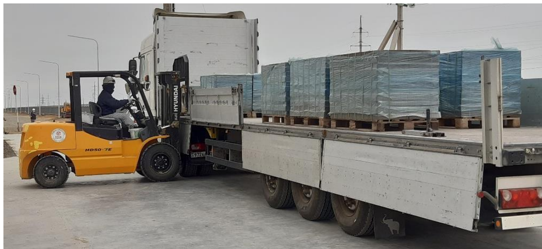
Рисунок 2 – Примеры упаковки, складирования и транспортирования бетонных тротуарных плит
